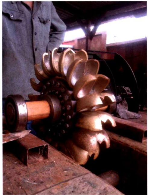
Photo 4 : Les premiers augets, fabriqués avec une école techniques de Tana, ont été montés à l'atelier Tsiky à Tana : le premier générateur de type pelton sera installé courant 2013
